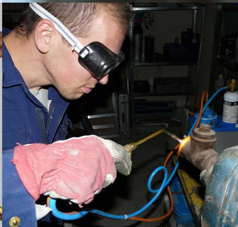
B-FLAME è una miscela di gas con aggiunta di chemtane, che aumenta il calore della fiamma. La temperatura della fiamma può arrivare fino ai 2.900°C. La bombola B-FLAME è prodotta in alluminio. Ha una capacità di 1 litro e contiene 385 gr. di prodotto - Valvola Aerosol - Attacco 7/16" 20 UNF (attacco più comunemente utilizzato in Europa). E' disponibile in confezioni da 6 bombole.
